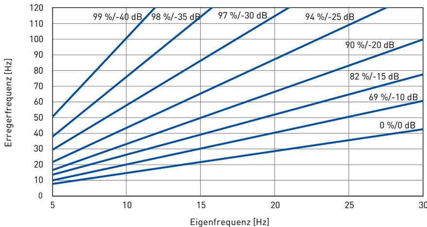
Dargestellt ist die Isolierwirkung für einen Ein-Massen-Schwinger auf starrem Untergrund mit DAMTEC® vibra 1500.
