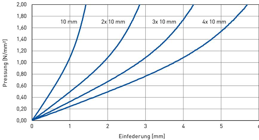
Aufgezeichnet wurde jeweils die 3. Belastung, Prüfung bei Raumtemperatur zwischen ebenen Stahlplatten. Prüfung in Anlehnung an DIN EN 826
