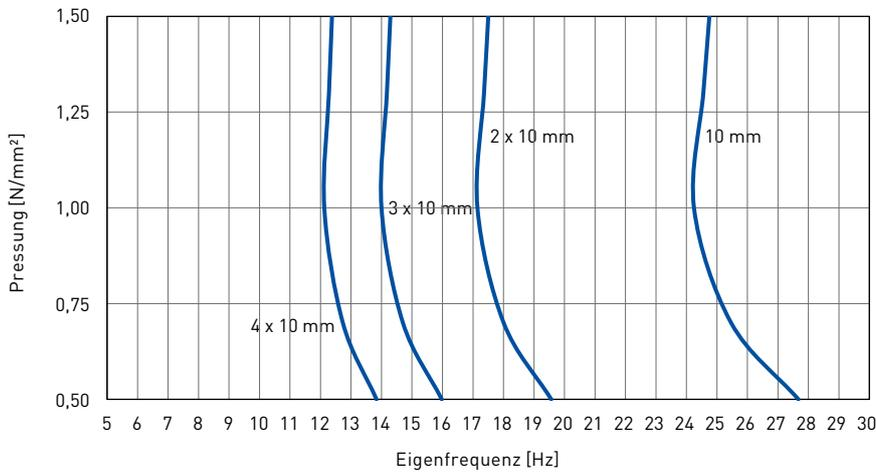
Eigenfrequenz des Systems bestehend aus einer kompakten Masse und einer elastischen Lagerung aus DAMTEC® vibra 1500 auf starrem Untergrund.
