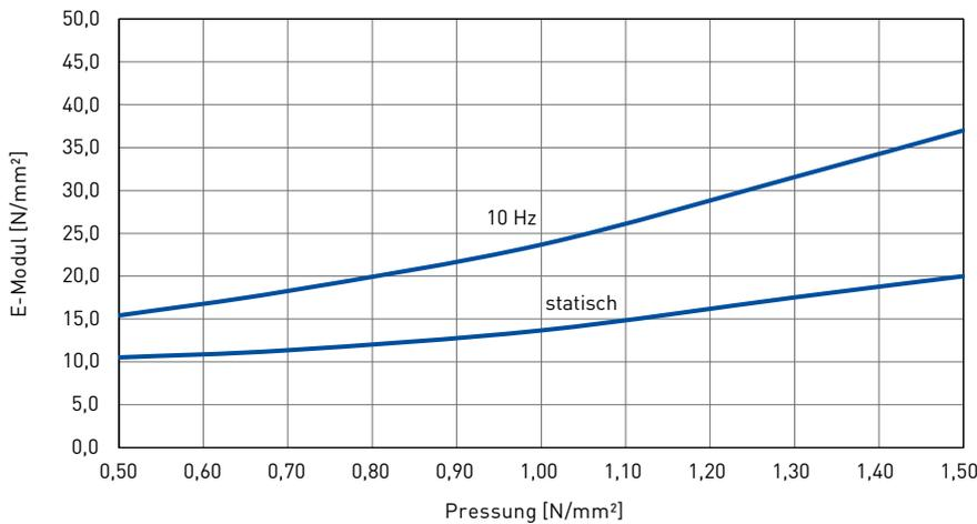
Dynamische Prüfung: harmonische Anregung mit einer Amplitude von  $\pm 0,25$  mm bei 10 Hz
