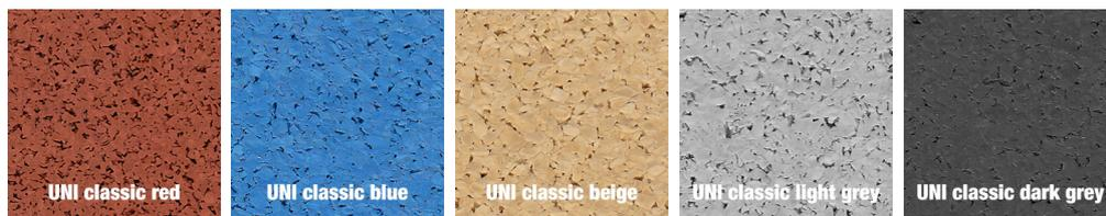
Surface: Fins granulés colorés d'EPDM agglomérés avec de l'élastomère de polyuréthane
