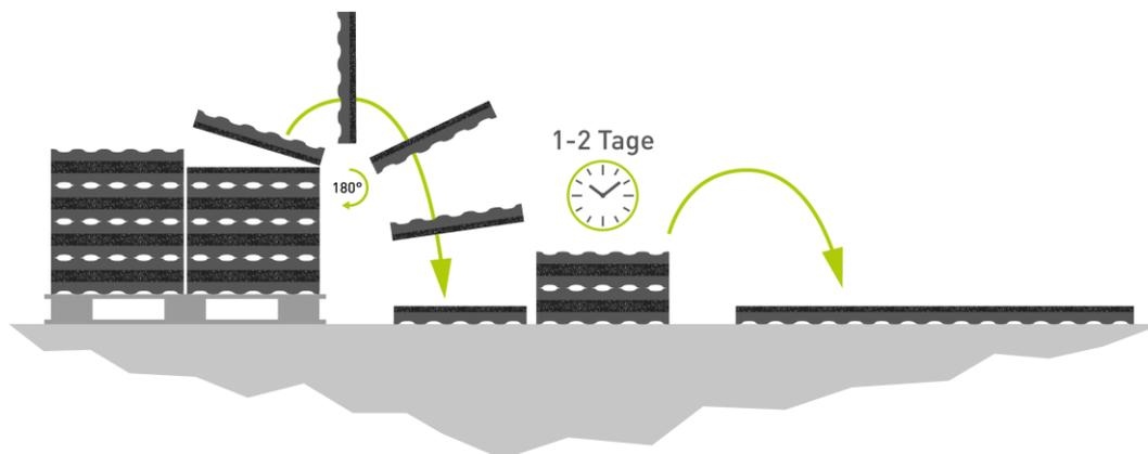
La température de stockage et d'installation des dalles **SPORTEC®** doit être comprise entre 15°C et 25°C. On peut tracer une ligne à la craie pour simplifier la pose.
